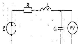
Определить показание вольтметра электромагнитной системы.
