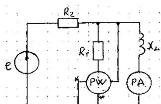
Определить показание ваттметра, если амперметр показывает 5 А.
