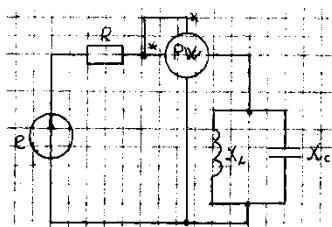
Определить показание ваттметра.
