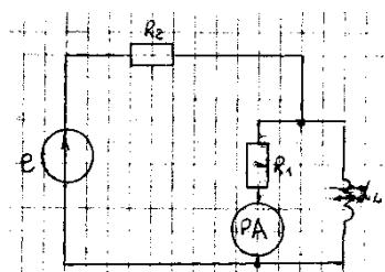
Определить ток в источнике питания, если амперметр показывает 5А.
