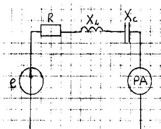
Определить показание амперметра.
