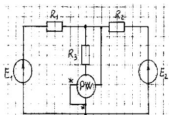
В электрической схеме определить показание ваттметра.
