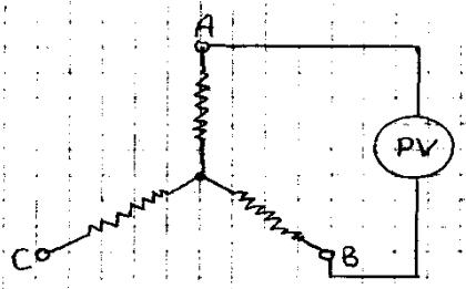
Определить показание вольтметра электромагнитной системы в ненагруженной цепи.
