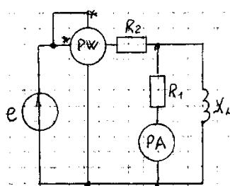
Определить показание ваттметра, если амперметр показывает 5 А.
