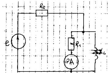
Определить ток в источнике питания, если амперметр показывает 5А.
