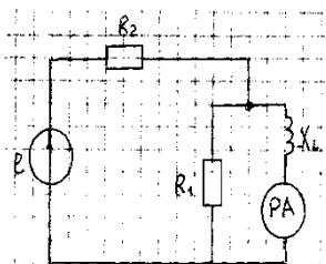
Определить ток в источнике питания, если амперметр показывает 5 А.
