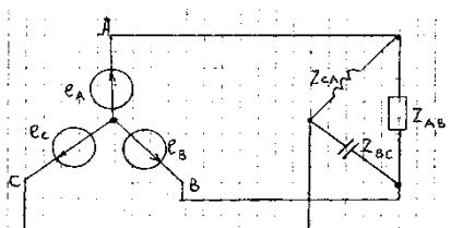
Определить фазный ток нагрузки, соединенной в «треугольник».
