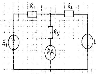
В электрической схеме определить показание амперметра.
