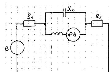
Определить ток в источнике питания, если амперметр показывает 10 А.
