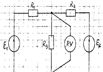
В электрической схеме определить показание вольтметра.
