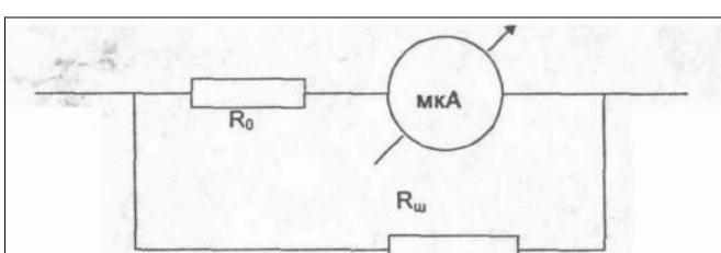
измерения силы тока до 10 мА? Схема подключения шунта приведена на рис. 7.
