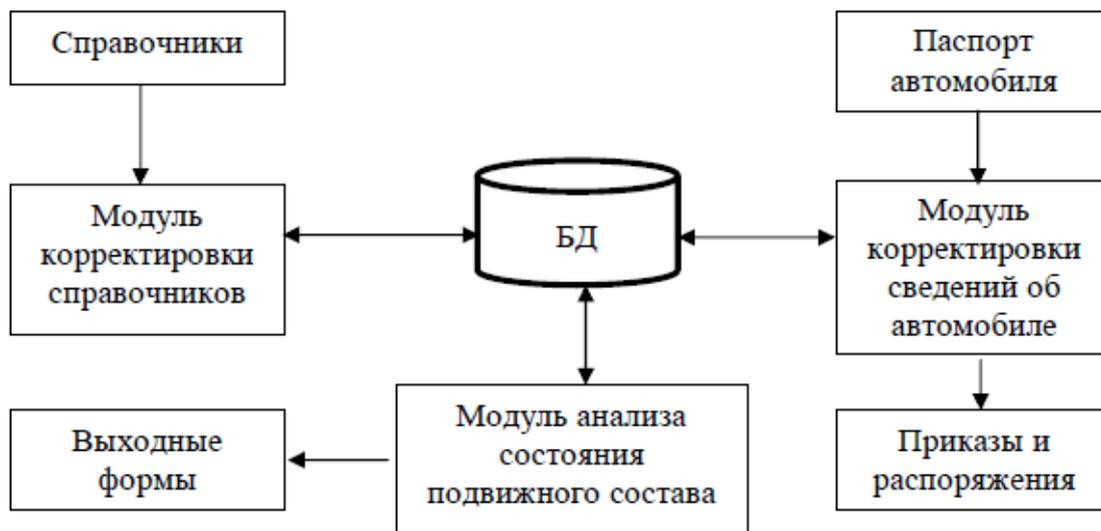
Рисунок 4 - Функциональная схема АРМ технического отдела
