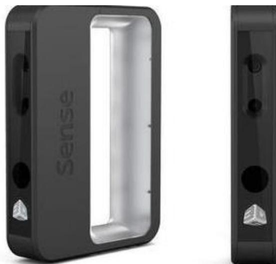
Рисунок 2.5 -3D сканер **Sense**
