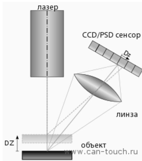
Рисунок 2.3 -Принцип работы датчика лазерной триангуляции.
