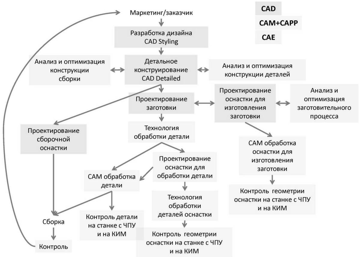
Рисунок 1.1 - Разработка изделия при применении компьютерных средств
