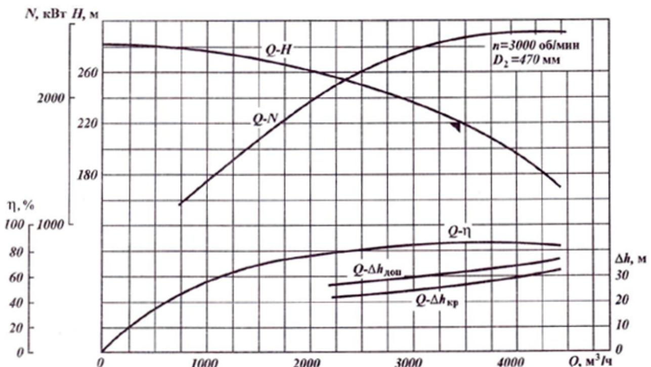
Рисунок А.10 – Рабочая характеристика насоса НМ 5000-210
