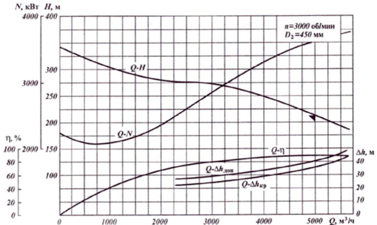
Рисунок А.11 – Рабочая характеристика насоса HM 5000-210
