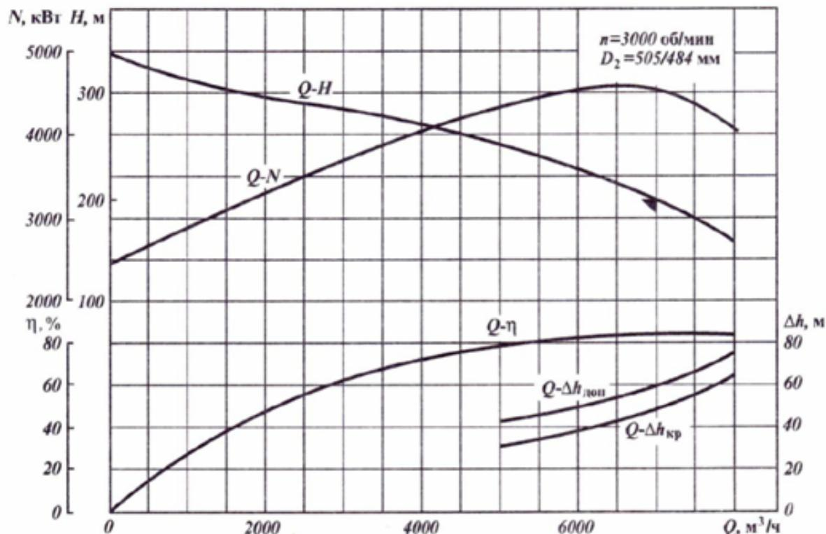
Рисунок А.16 – Рабочая характеристика насоса НМ 10000-210 со сменным ротором на подачу  $7000 \text{ м}^3/\text{ч}$
