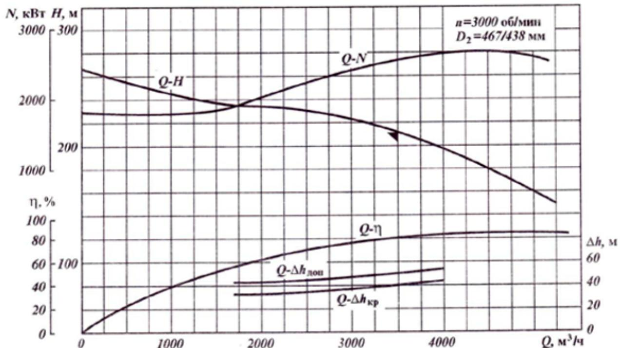
Рисунок А.12 – Рабочая характеристика насоса HM 7000-210 со сменным ротором на подачу  $3500 \text{ м}^3/\text{ч}$
