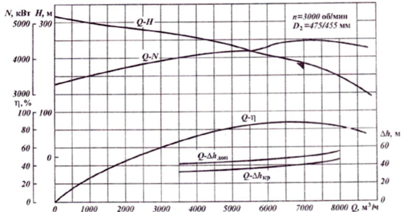
Рисунок А.14 – Рабочая характеристика насоса НМ 7000-210
