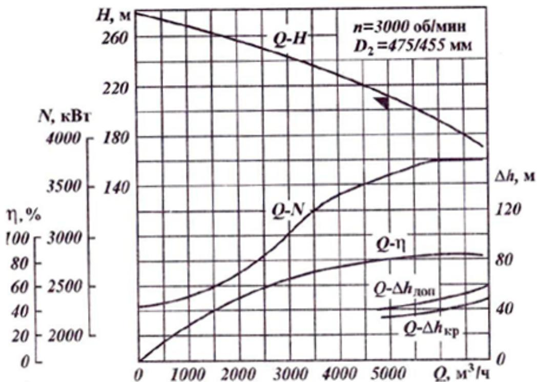
Рисунок А.15 – Рабочая характеристика насоса НМ 10000-210 со сменным ротором на подачу  $5000 \text{ м}^3/\text{ч}$
