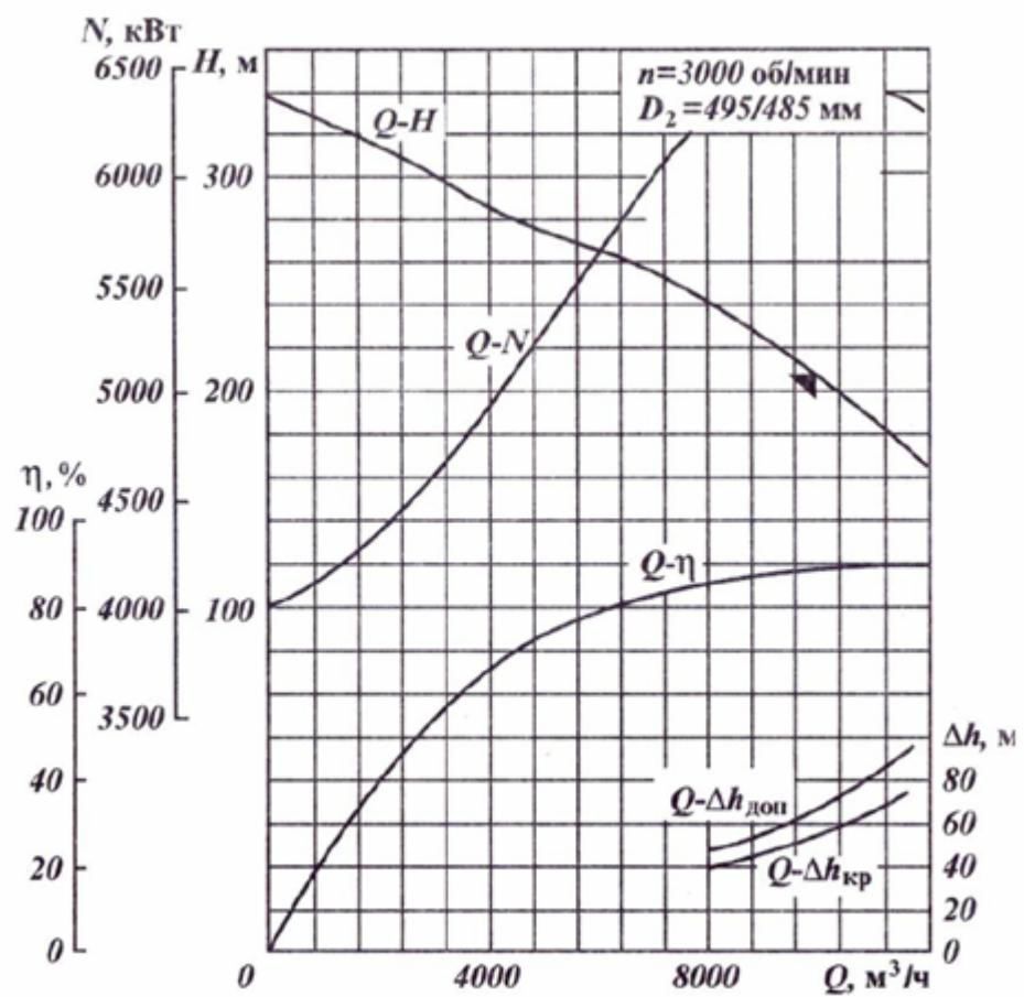
Рисунок А.17 – Рабочая характеристика насоса НМ 10000-210
