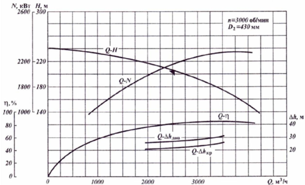
Рисунок А.9 – Рабочая характеристика насоса НМ 5000-210
