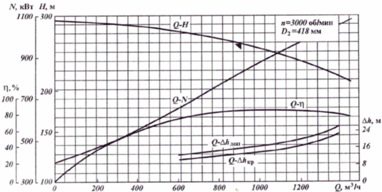
Рисунок А.1 – Паспортная характеристика насоса НМ 1250-260 со сменным ротором на подачу 900 м<sup>3</sup>/ч
