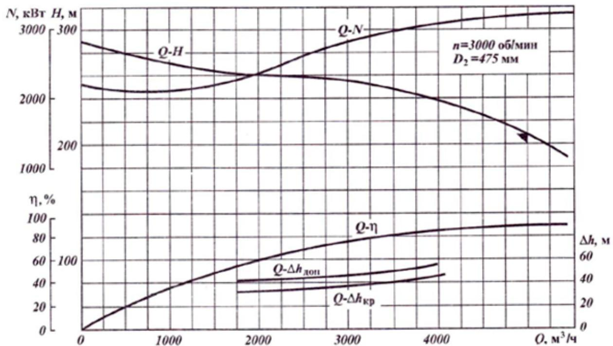
Рисунок А.13 – Рабочая характеристика насоса НМ 7000-210
