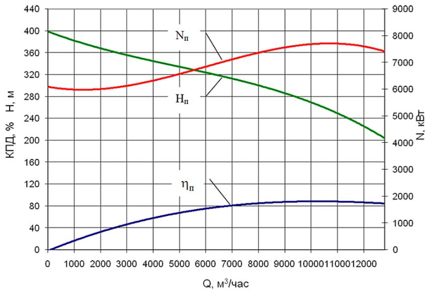
Рисунок 2 – Паспортная характеристика насоса марки НМ 10000-210 со сменным ротором на подачу 12500 м<sup>3</sup>/ч ( $D_2=530$  мм)
