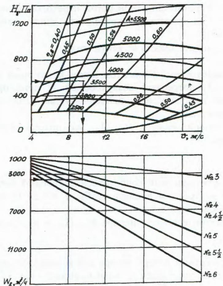
Рис. 1.1. Номограмма для выбора центробежного вентилятора
