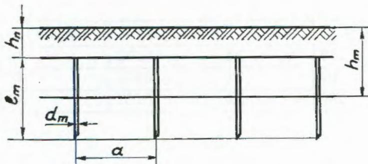
Рис. 2.2. Схема заземляющего устройства
