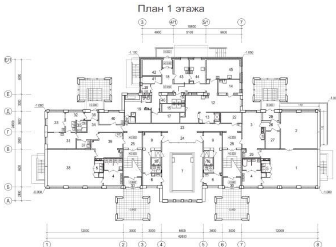
Рисунок 1. Вариант задания на расчетно-графическую работу - план первого этажа здания, для которого требуется составить проектно-сметную документацию
